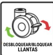
Desbloquear/ bloquear llantas: Indica el sentido en el que se debe presionar el freno para bloquear o desbloquear las ruedas.
